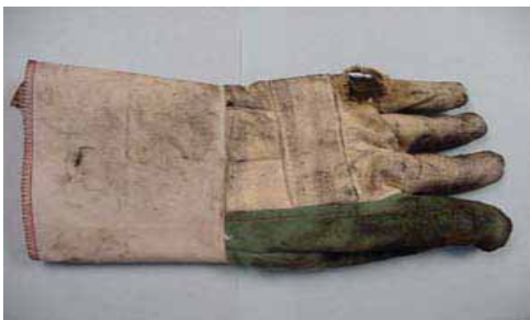
Figura 1. Guante dañado por un soplete con fuga
